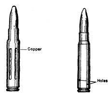
Figure 112.—Dummy cartridges (Exerzierpatronen).
