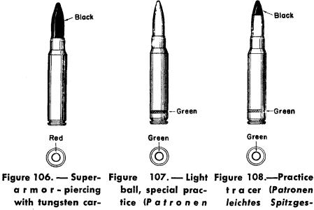
with tungsten carbide core (Patronen Spitzgeschoss mit Stahlkern gehärtet).
